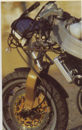
Gros plan sur le train avant où l'on remarque la position centrale du disque de frein, le bras en fonderie, le tube coulisant et les biellettes de liaison.
