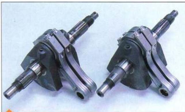
Comparaison des deux vilebrequins. A gauche, le nouveau dont la course passe de 66mm à 63,5mm. Autre différence notable : le calage du rotor d'alternateur n'est plus assuré par un cône et une clavette, mais par des cannelures. Les bielles Pankl sont d'excellente facture, certainement, avec les Carillo, les meilleures du marché.
