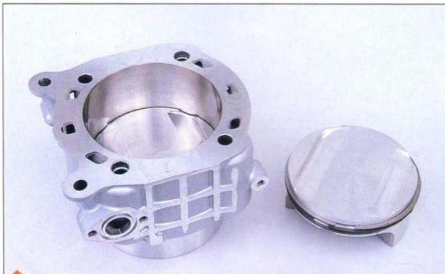
Le ciel du piston Asso de 100 mm de diamètre est pratiquement plat grâce à la faible inclinaison des soupapes nécessitant de plus petites empreintes. L'axe flottant a un diamètre de 20 mm.
