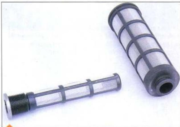
À gauche, l'ancien pré-filtre monté horizontalement, à droite le nouveau. La plus grande surface filtrante a permis une réduction des pertes de charge à l'aspiration.
