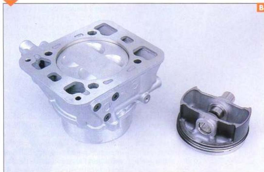
défendre le titre mondial contre la Honda bicylindre de Colin Edwards. Sa structure générale est quasi identique à celle du SPS, à savoir : cylindres en L, distribution double arbres commandée par courroies crantées, commande desmodromique des quatre soupapes par cylindre, alimentation par injection, embrayage à sec et boîte six rapports.
